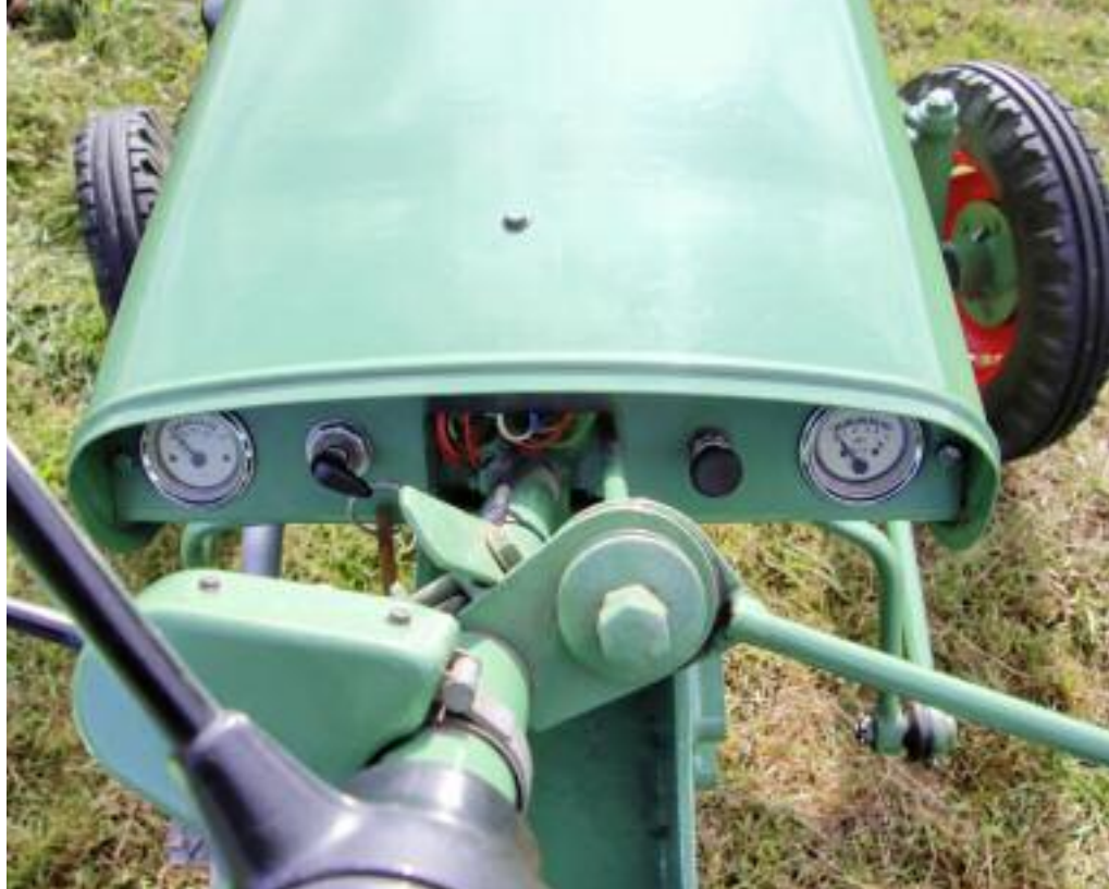
Die Instrumente des ADN beschränken sich auf die Anzeige der Kühlwassertemperatur (links, optional) und des Öldrucks (rechts). Beim ADN gibt es einen Abstellhebel in Form einer Blechlasche (an der Lenkstange, Bildmitte), ...
