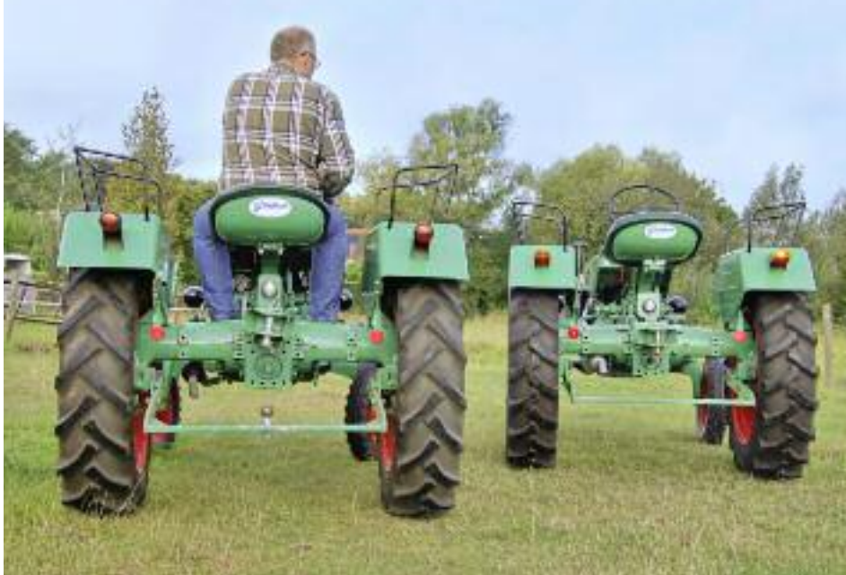
Auch in der Rückansicht zeigen sich ADN und ALD als weitgehend gleich aufgebaute und fast gleich große Schlepper, bei denen hier besonders die Hinterachsen in Portalbauweise auffallen
