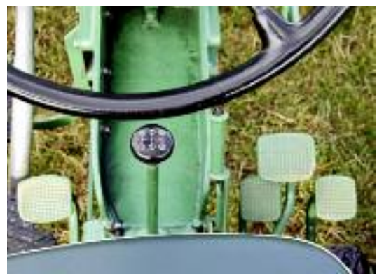
Die Getriebe lieferte ZF – erst das A-5, ab 1955 das A-5/5 mit 5/1 (im Bild) und das A-5/6 mit 6/1 Gängen
