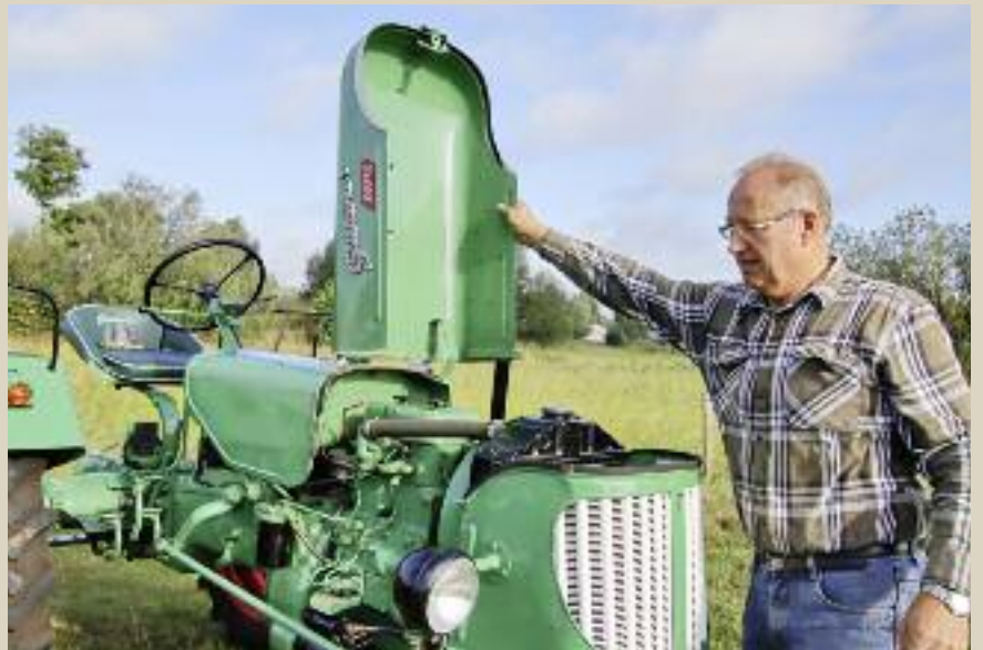
Links oben: Der wassergekühlte Güldner-Motor des Typs 2 DNS hat im Laufe seines Einsatzlebens einen Blockriss durch gefrorenes Kühlwasser erlitten, konnte aber geschweißt werden. Rechts oben: Für den ALD hat Gert Lamberts diese Stütze für die Motorhaube gefertigt, um Wackeln und Vibrieren zu minimieren. Unten: Blick unter die Motorhaube auf den 2 DNS – hier war eine zusätzliche Stütze, wie Gert sie für den ALD angefertigt hat, nicht nötig
